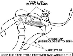
LOOP THE NAPE STRAP FASTENER TABS AROUND THE CORNERS OF THE CHINSTRAP AND SNAP CLOSED. AFTER CLOSURE, THE SNAPS WILL BE ON THE OUTSIDE, AWAY FROM YOUR CHIN.
